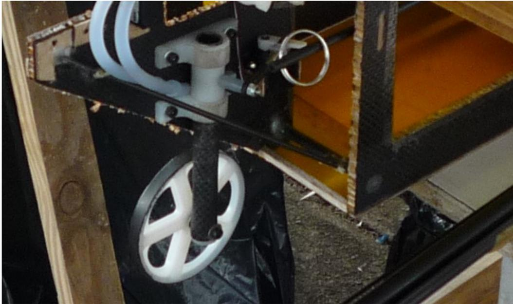
Esta foto mostra uma parte da fuselagem da equipe campeã de 2013 na classe regular, notem o emprego das fibras de carbono no trem de nariz (bequilha), e na fuselagem, sendo esta confeccionada por material sandwich de fibra de carbono e Honeycom, as treliças também foram feitas com varetas de fibra de carbono.
