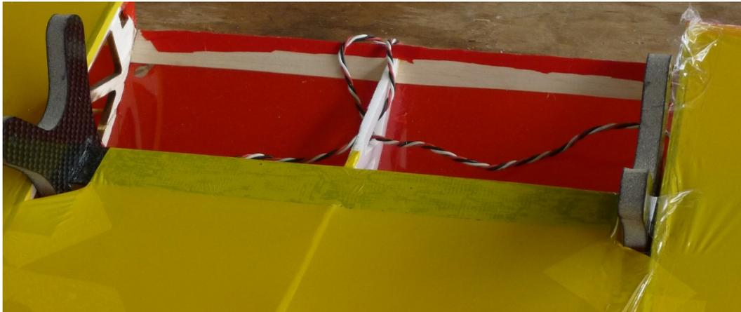
A foto acima mostra a junção da asa com a fuselagem, utilizada por uma equipe de Aerodesign. Vemos essa estrutura confeccionado por um sandwich de fibra de carbono com a espuma PVC Divinycell.
